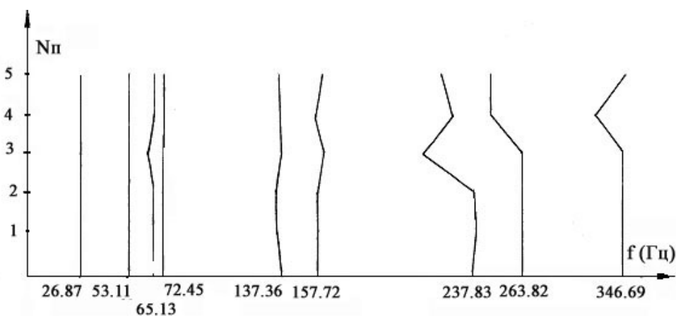
Рис. 4. Изменение собственных частот при изменении квазиупругих характеристик подшипников
