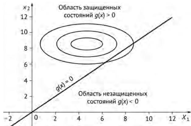
Рис. 4. Функция предельных состояний
