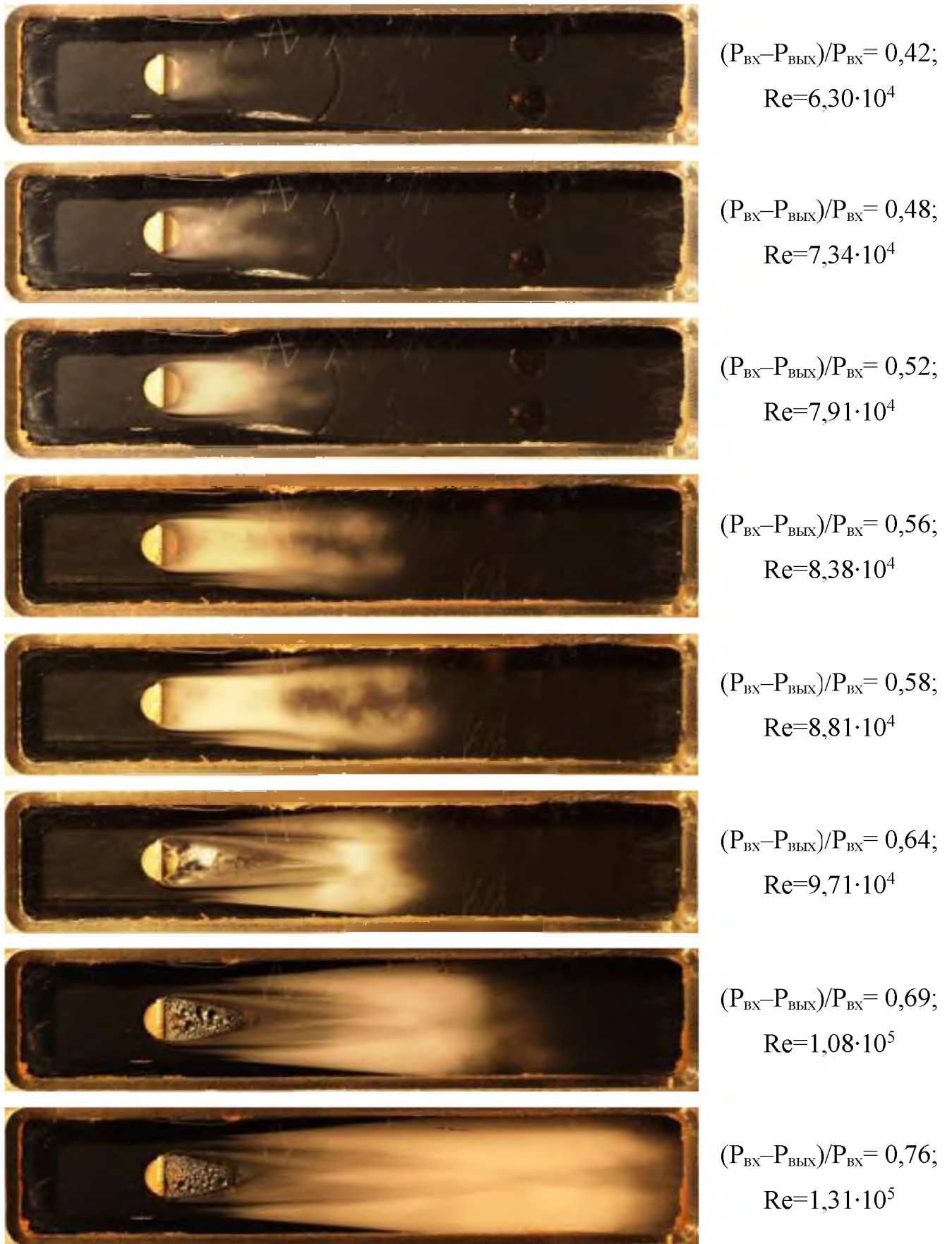
Рис. 8. Фрагменты картин течения в канале генератора с телом обтекания – пластина, расположенным в один ряд при P_{\text{BX}} = \text{var} , P_{\text{ВЫХ}} = \text{const}
