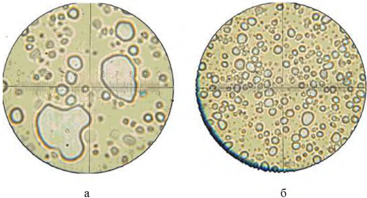
Рис. 5.4. Структура локального энергетического сырья (сырой нефти): а) – исходный; б) – приготовленный к сжиганию в виде водотопливной эмульсии.
