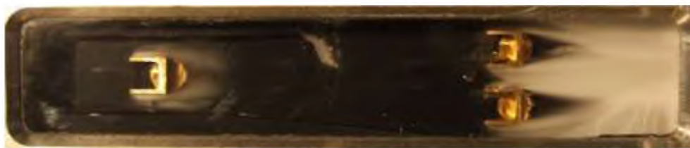
Рис. 11. Фотографии картин течения в канале генератора с телом обтекания – стакан, расположенным в два ряда при P_{\text{BX}} = \text{const} , P_{\text{ВЫХ}} = \text{var}
