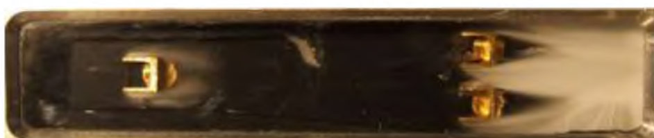
Рис. 3.1. Фрагменты картин визуализации кавитационных зон в канале генератора с различными телами обтекания при P_{\text{вх}} = \text{const} , P_{\text{вых}} = \text{var}
