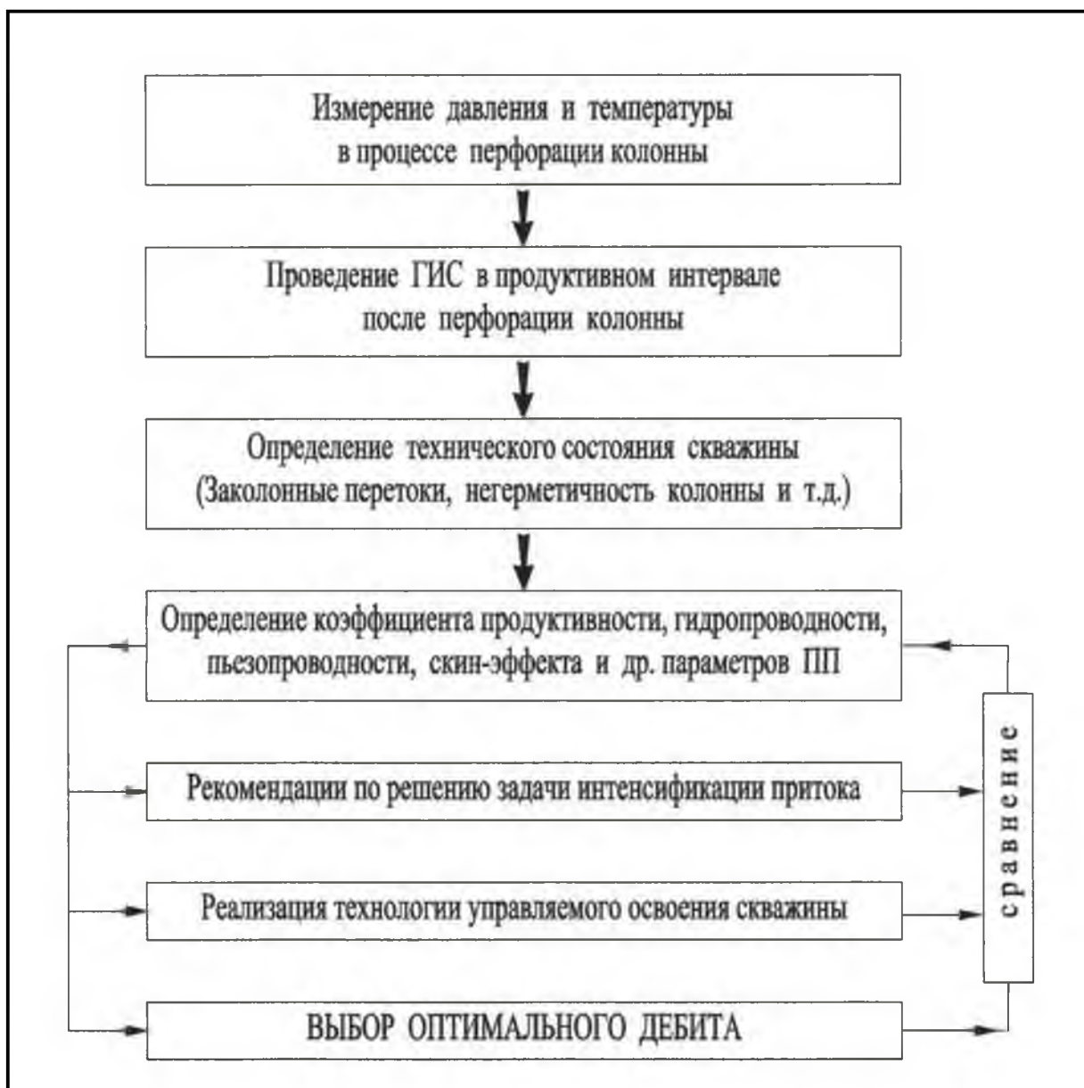
Рис. 36. Алгоритмическая взаимосвязь информационных блоков при реализации управляемого освоения скважины и вводе ее в эксплуатацию.
