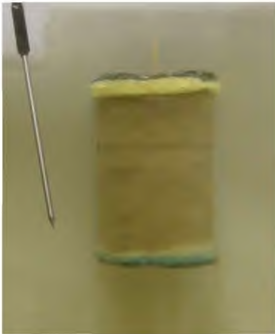
Рисунок 2.18 – Процесс разрушения мёрзлого песчаного образца в воде с использованием прижимных теплоизолирующих прокладок
