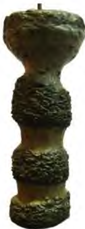
Рисунок 2.14 – Форма песчаного образца с переслаиванием суглинка и песка после частичного разрушения
