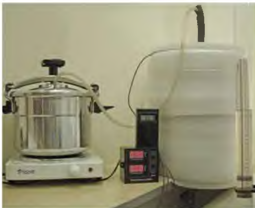
Рисунок 2.10 – Лабораторная установка по созданию модели резервуара в мёрзлом грунте
