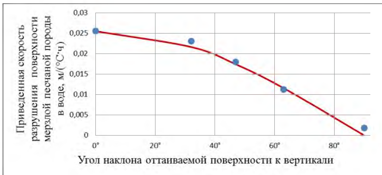
Рисунок 4.3 – Методически задаваемая и экспериментально определённая зависимость скорости разрушения поверхности мёрзлой песчаной породы в воде от её угла наклона к вертикали
