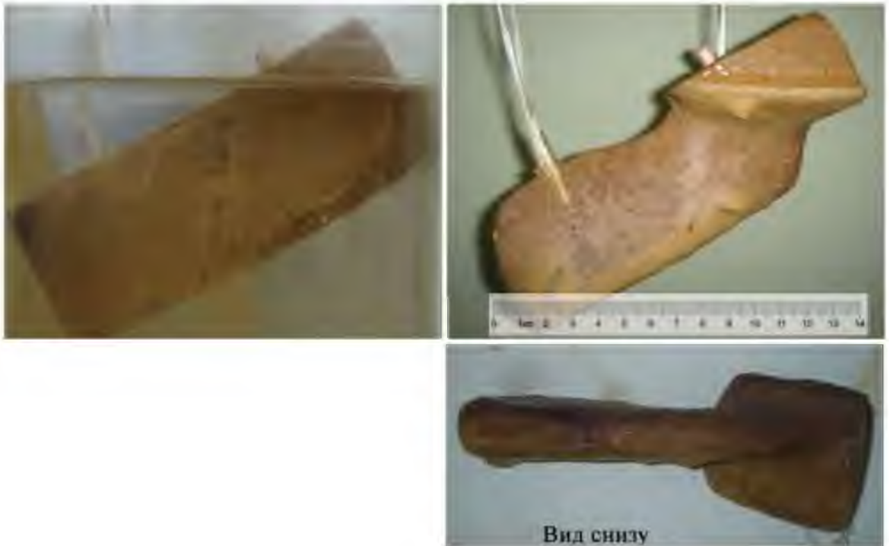
Рисунок 2.7 – Изображение начального и конечного моментов разрушения наклонённого мёрзлого образца в воде
