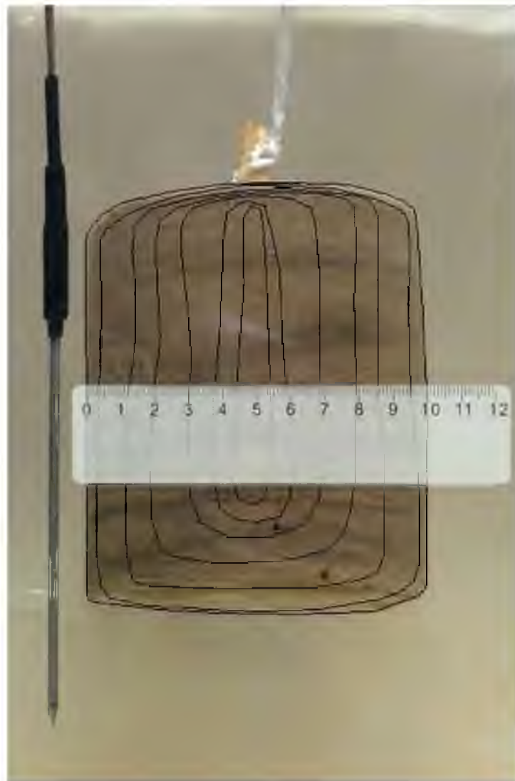
Рисунок 2.3 – Динамика разрушения образца мёрзлого грунта
