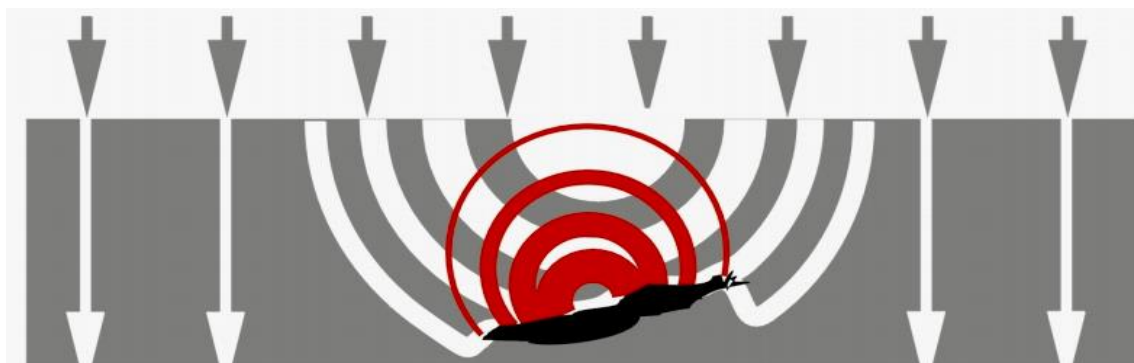
Рис. 2- Схема выявления дефекта при активном инфракрасном термографировании
