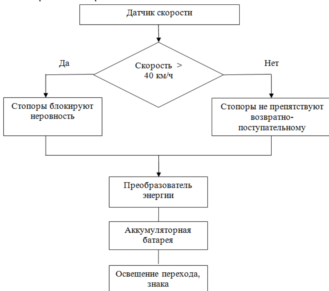
Рис.2. Блок - схема работы искусственной неровности
