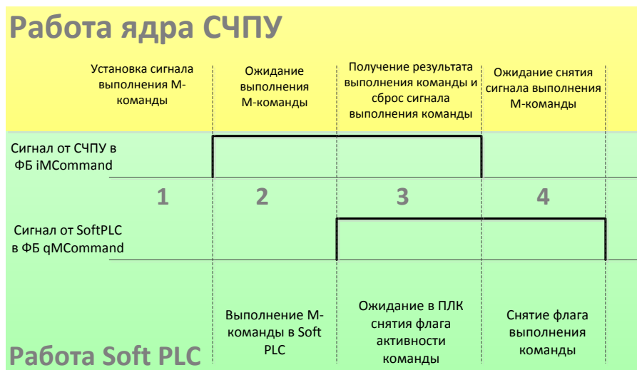
Рис. 3 Циклограмма выполнения М-команды с использованием функциональных блоков iMCommand и qMCommand
