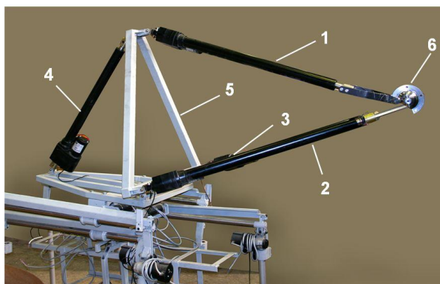
Рис. 1. Манипулятор – трипод на поворотном основании
