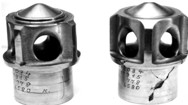
Рис. 2. Характер разрушения клапанов металлургического происхождения и несоблюдения технологических режимов обработки, в результате которых снижаются механические характеристики материала, особенно характеристики трещиностойкости.
