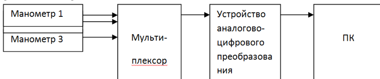
Рис.2. Структурная схема автоматизации гидравлических испытаний
