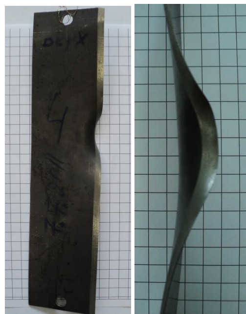
Рис. 2. Общий вид пластины с повреждением кромки
