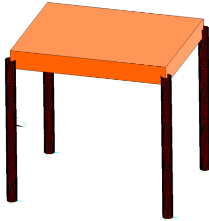
Рис. 2. Конечно-элементная модель конструкции, показаны поперечные сечения элементов
