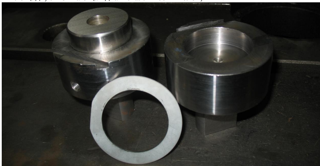
Рис.2. Оснастка и установленный образец
