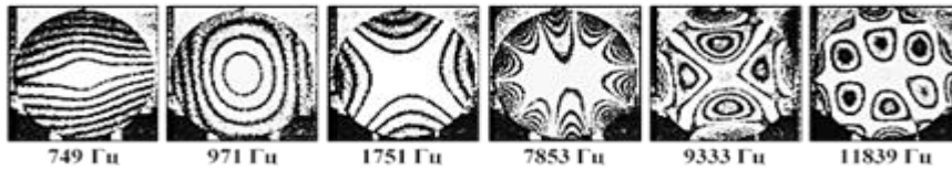
Рис.2. Спекл-интерферограммы форм колебаний композитного (анизотропного) диска с центральным жестким креплением.
