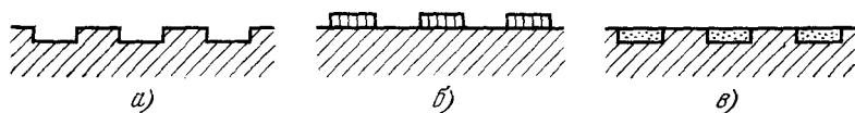
Рис. 12.8. Типы рассеивателей ПАВ: а) канавки, б) металлические или диэлектрические полоски, в) неоднородности, получаемые внедрением примесей.
