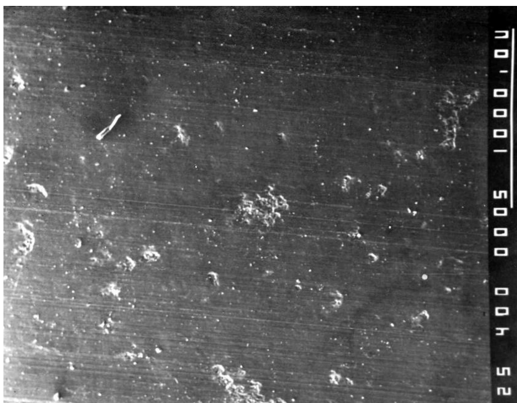
Рисунок 3.2 - Внешний вид приработанной поверхности образца с ТСП (x 40)
