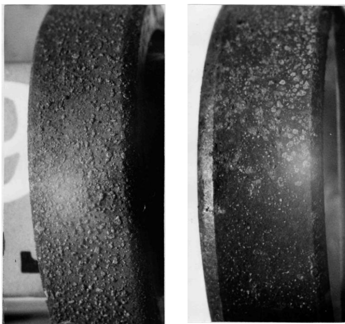
Рисунок 5.26 - Поверхности неприработанного образца с ТСП ВНИИ НП 212 (слева) после выдержки в атмосфере соляного тумана в течение 5 суток (увел. х 6) и образца с ТСП ВНИИ НП 212М (справа) после выдержки в атмосфере соляного тумана в течение 5 суток (увел. х 6)
