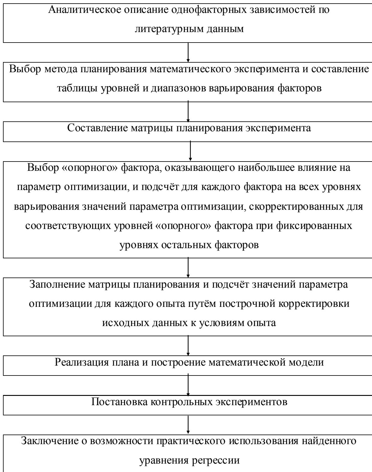
Рисунок 3.13 –Этапы основанного на математическом эксперименте расчётного метода комплексной оценки триботехнических характеристик узлов трения с ТСП
