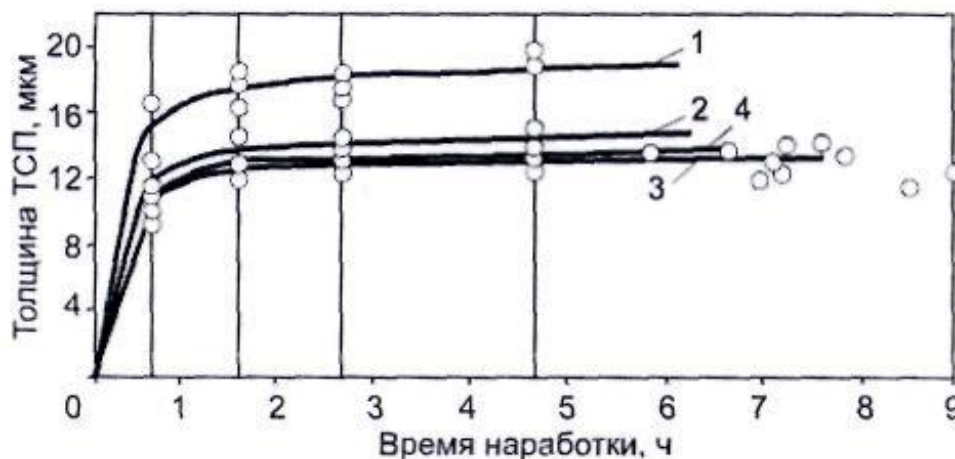
Рисунок 3.7 - Динамика изменения величины износа ТСП ВНИИ НП 212 в парах трения 30ХГСА (HRC = 38-42 ед.) x ШХ 15 (HRC > 60 ед.) по мере наработки (1 – образцы № 12,13; 2 - № 10, 11; 3 - № 1-7; 4 - № 8,9)
