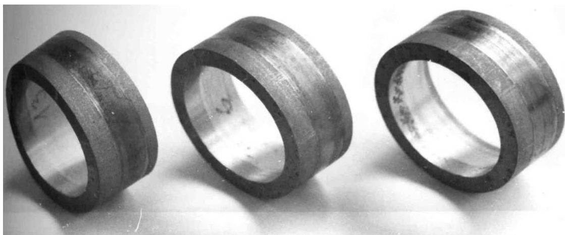
Рисунок 2.29 – Внешний вид широких образцов с дорожками трения, полученными после наработки (ТСП ВНИИ НП 212)
