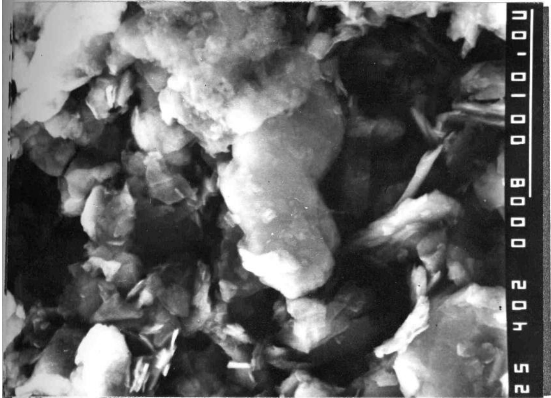
Рисунок 3.3 – Структура исходной поверхности образца с ТСП (x4000)
