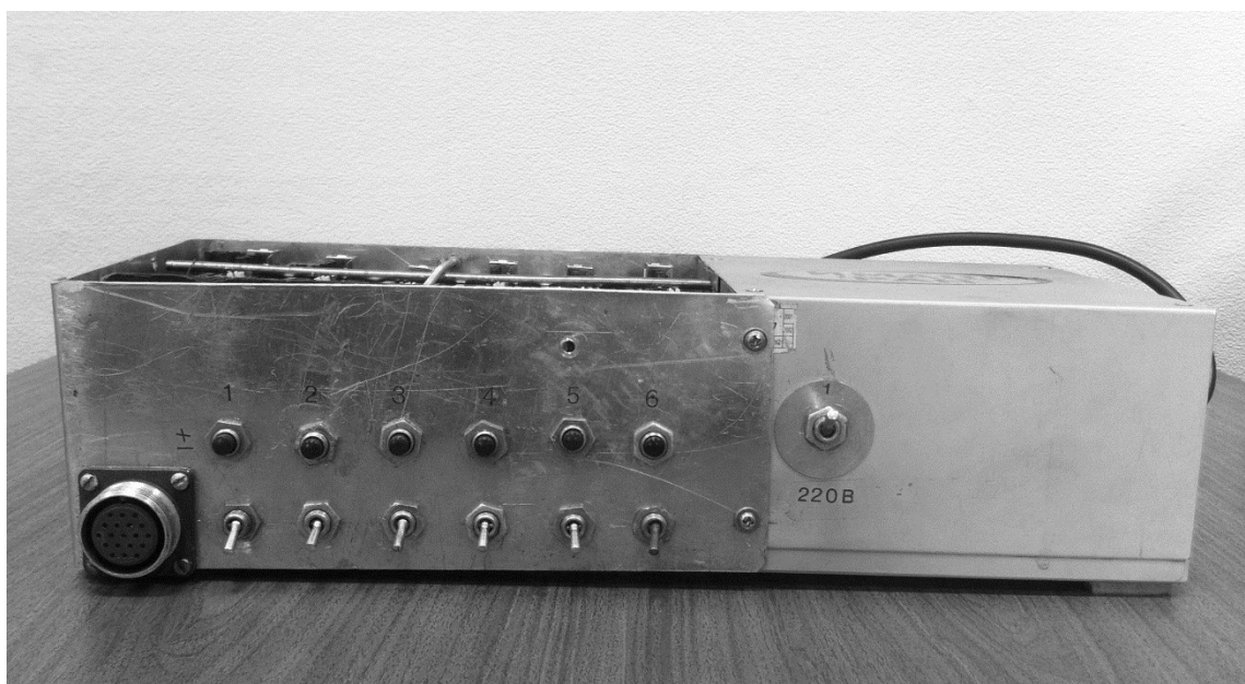
Рис. 5.16. Блок питания с контроллерами в едином металлическом корпусе
