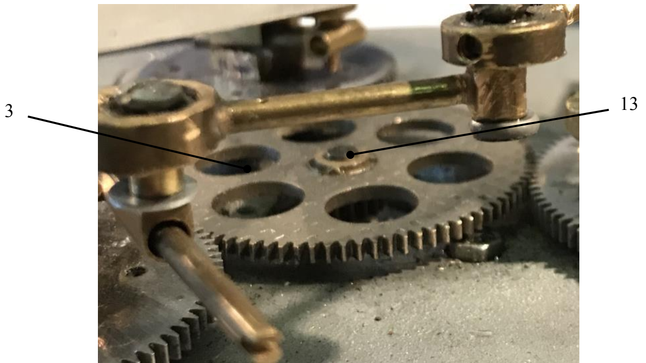
Рисунок 5.1. в) – Общий вид механизма (вид сбоку): 3 – ведущая шестерня; 13 – ось электродвигателя.
