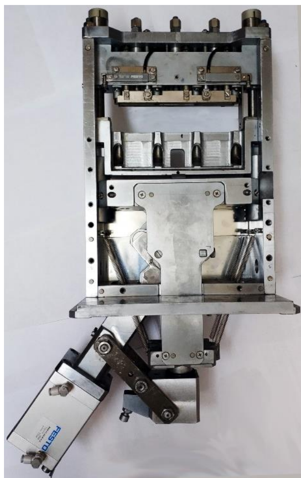
Рис. 16. Двухпоточный механизм силовой станции с одним приводом.
