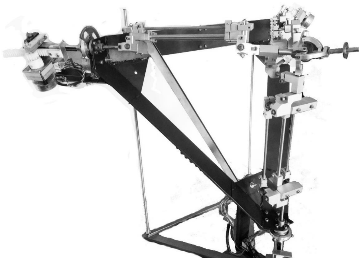
Рис. 10. Макет механизма параллельной структуры с 6-ю степенями свободы и групповой кинематической развязкой движений.
