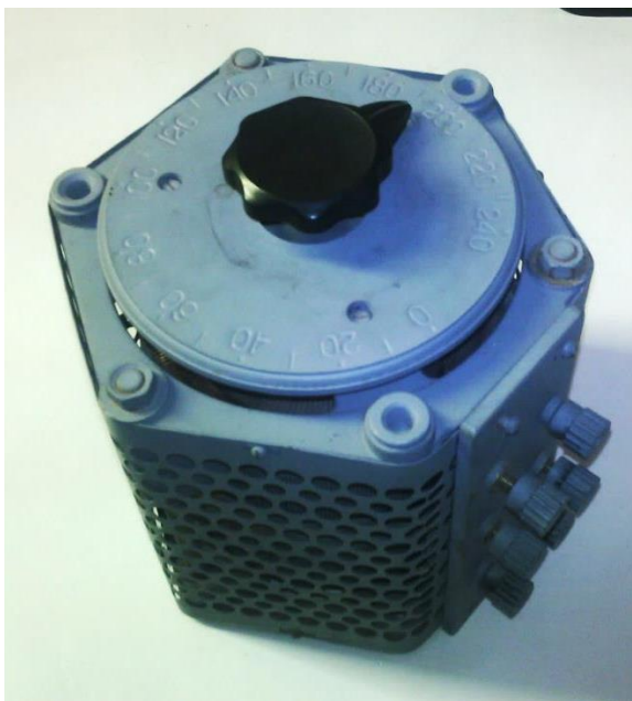
Рисунок 3.4 – Внешний вид регулятора напряжения установки ЭЭД
