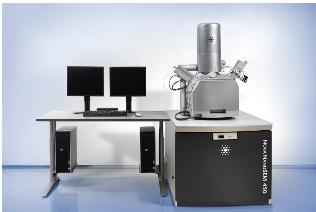
Рисунок 3.10 – Растровый электронный микроскоп Nova NanoSEM 450
