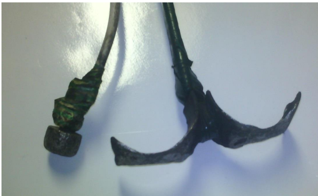
Рисунок 3.2 – Электроды, собранные из отходов стали ШХ15
