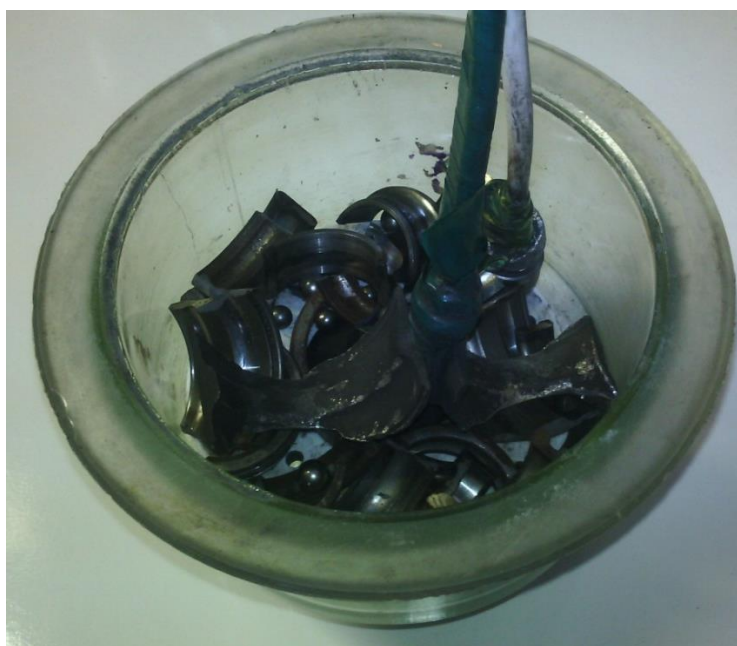
Рисунок 3.8 – Реактор экспериментальной установки ЭЭД
