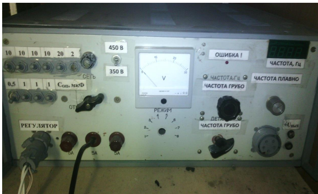
Рисунок 3.5 – Внешний вид генератора импульсов установки электроэрозионного диспергирования
