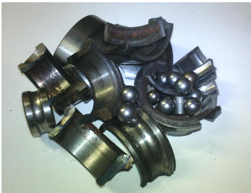
Рисунок 3.1 – Отходы шарикоподшипниковой стали марки ШХ15
