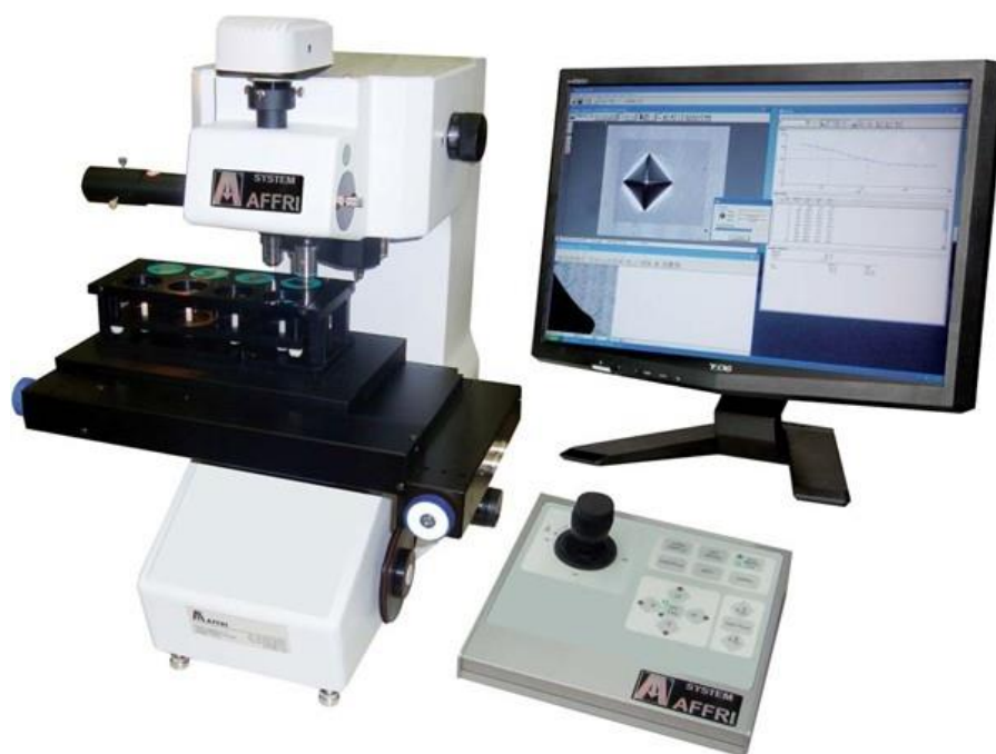
Рисунок 3.17 – Анализатор микротвердости DM-8
