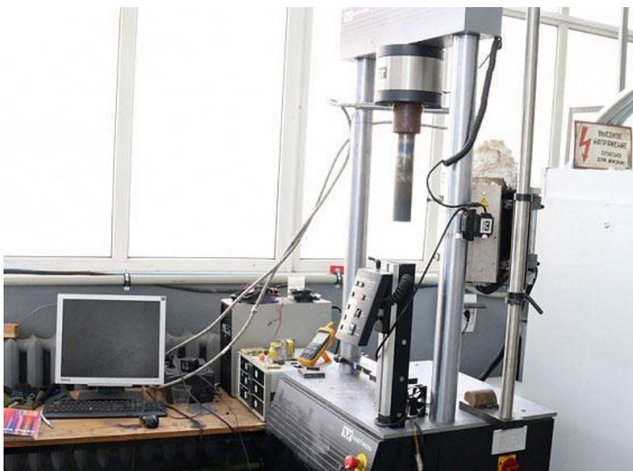
Рисунок 3.18 – Напольная электромеханической испытательной машине «Instron 300LX-B1-C3-J1C»
