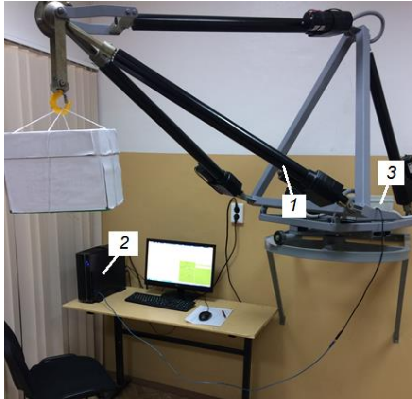
Рисунок 5.1 – Внешний вид экспериментальной установки: 1- манипулятор параллельно-последовательной структуры на основе трипода; 2 – управляющая ЭВМ; 3 – электронный блок системы управления
