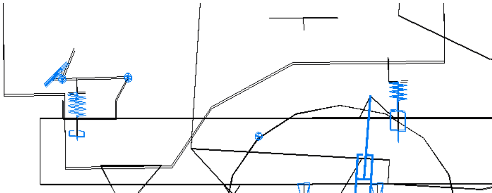
Рис. 7.3.2. Элементы новой расчётной схемы виброзащитной системы кабины в составе грузового автомобиля
