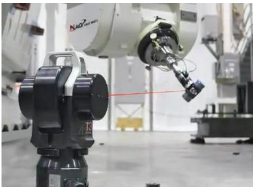
Рис. 5.14. Общий вид прибора Laser Tracker V.E.C.
