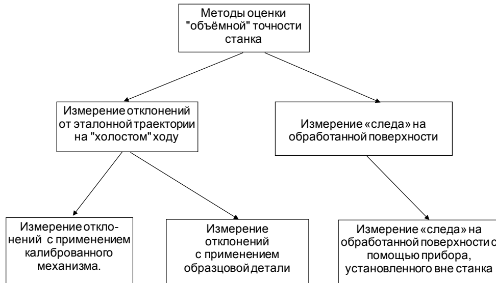
Рис. 5.1. Классификационная схема методов оценки «объёмной» точности станка
