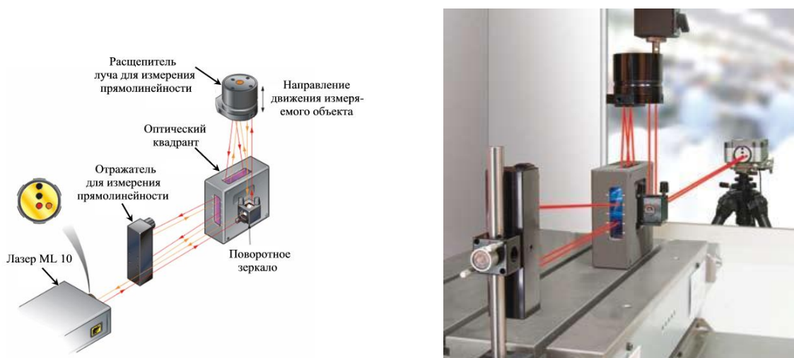
Рис.4.8. Измерение отклонений от перпендикулярности движений исполнительных органов станка: а) набор оптики и принцип направления лучей лазера, б) измерение отклонений от перпендикулярности в пл. XZ на станке с вертикальным шпинделем
