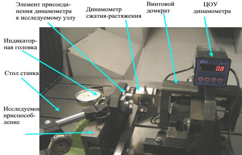
Рис. 7.28. Общий вид устройства измерения статической жесткости (податливости) несущей системы машины
