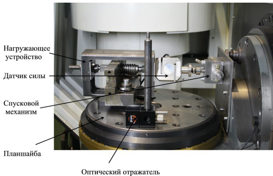
Рис. 7.5. Общий вид станка, подготовленного для измерения отклика несущей системы на ступенчатое силовое воздействие (планшайба - станна)
