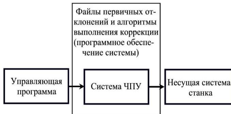
Рис. 1.7. блок-схема системы коррекции по результатам калибровки станка, инструмента и приспособления, установленного на станке
