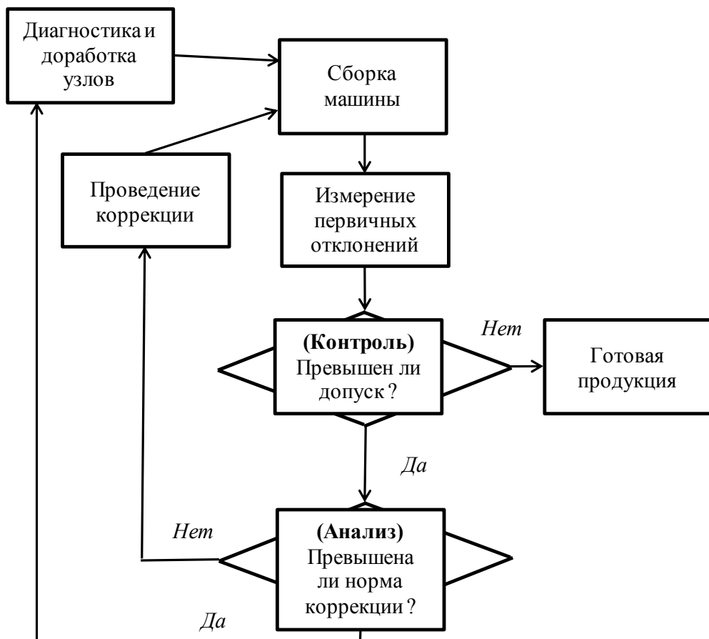
Рис. 7.41. Процесс калибровки многокоординатной машины с ЧПУ
