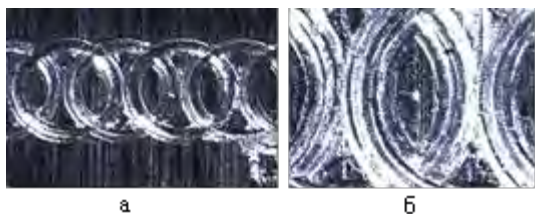
Рис. 2. Засверливание покрытия алмазным сверлом: а - x50, б - x100.
