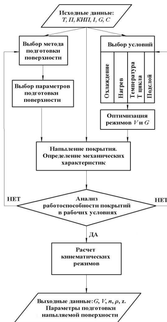
Рис. 2. Алгоритм определения параметров процесса плазменного нанесения многослойных покрытий повышенной толщины
