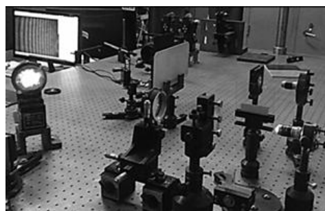
Рис. 2. Оптическая схема спекл-интерферометра
