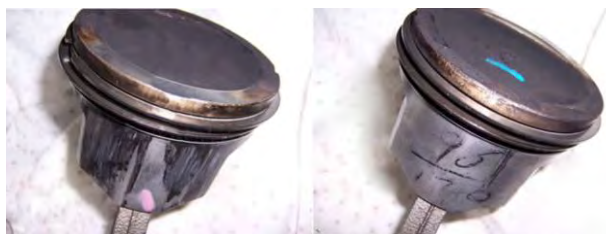
Рис.1. Вид Н- (слева) и НН сторон юбки одного и того же поршня автомобильного двигателя после эксплуатации
