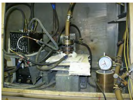
Рис.. 2. Общий вид установки для обработки образцов в парах селена.
