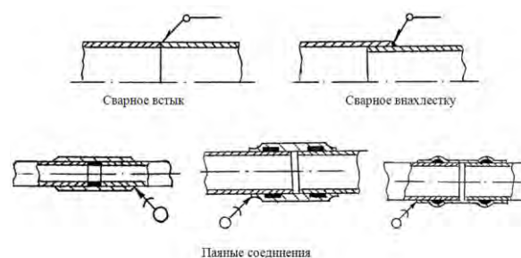
Рис.1. Способы сварки и пайки для соединений трубопроводов
