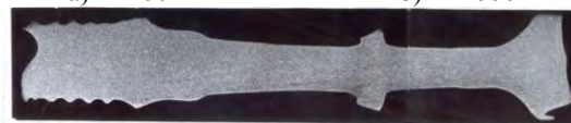
Рис. 5. Микро- и макроструктура раскатанного диска из сплава ЭП742 при 1050 °C ( \gamma + \gamma' -область) в состоянии поставки (а), после изотермической раскатки (б) разрез полотна диска (в).
