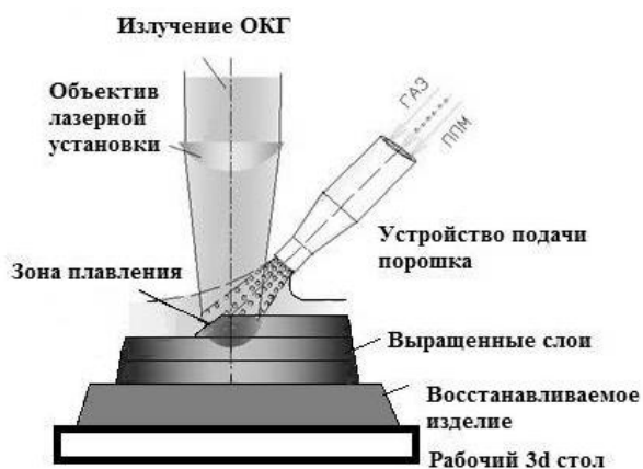
Рис. 1. Схема процесса 3d-печати металлом с импульсным лазерным нагревом.
