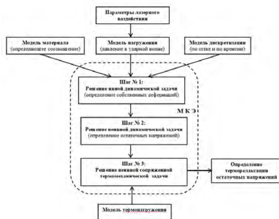
Рис. 1. Схема моделирования технологии ЛУВО и определения терморелаксации остаточных напряжений
