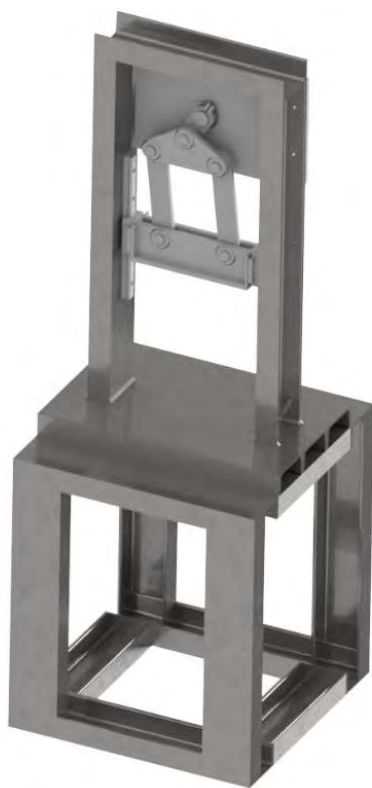
Рис. 9. 3-D модель кривошипного пресса на базе плоского рычажного механизма 4-го класса в системе Autodesk Inventor
