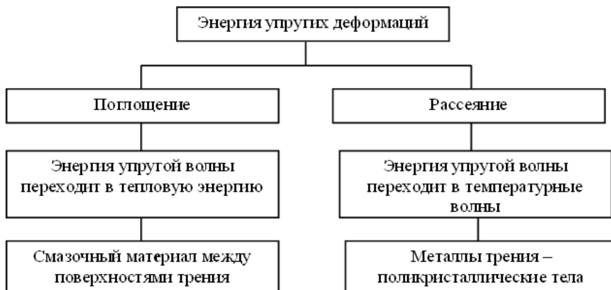
Рис. 2. Схема преобразования энергии упругой деформации в паре трения со смазочным материалом [2, 3, 5, 6].
