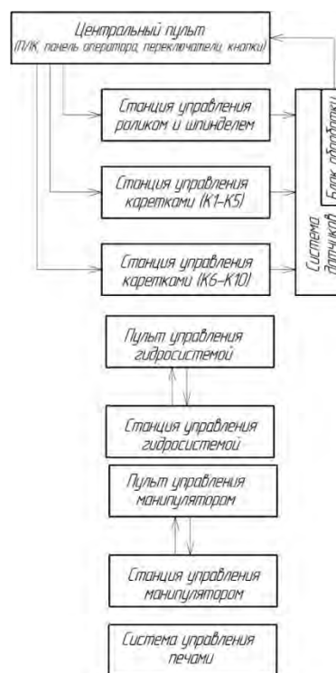
Рис. 3. Блок-схема АСУ ТП раскатного стана (на примере станов СРЖД-800, АЛРД-800)
