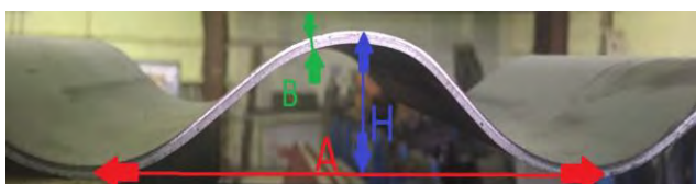
Рис. 4. Образец плоского СГЛ, полученного на экспериментальной установке роторного гофрирования. А – длина волны; Н – амплитуда волны; В – толщина стенки СГЛ.
