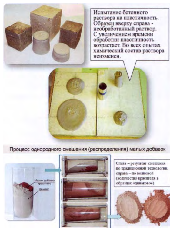
Рис. 10. Результаты процесса смешения порошковых материалов и получение однородного распределения красителя красного цвета (малого количества - 5% по массе) в основном материале (портландцементе).
