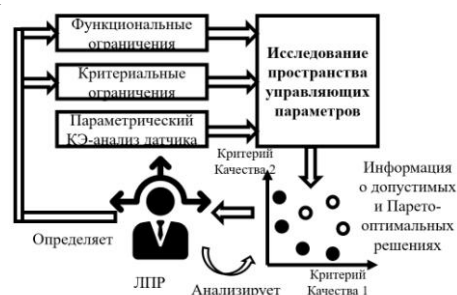
Рис. 1. Укрупненная схема предлагаемого подхода к автоматизации процесса проектирования тензорезисторных силоизмерительных датчиков
