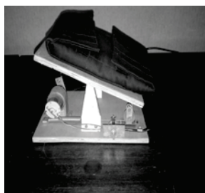
Рис.3 Лабораторный образец размораживателя плазмы крови на основе тканого электронагревателя.
