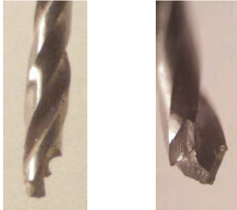
а) б) Рис. 1. Характерные виды разрушений свёрл: а – при осевом нагружении; б – при скручивании
