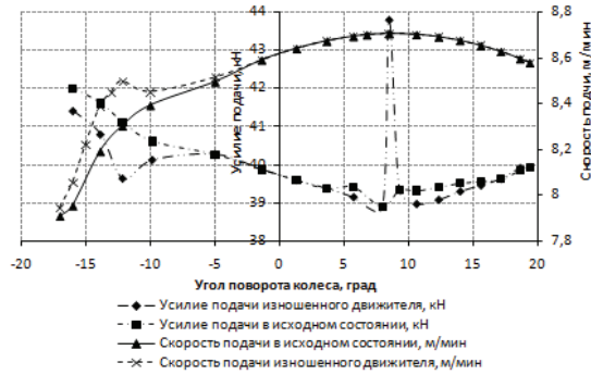
Рис.2. Изменение усилия и скорости подачи для двухэлементного движителя с зубчатой рейкой
