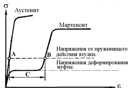
Рис. 3. Силовые характеристики материалов муфты и втулки, в зависимости от температуры.
