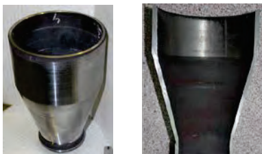
Рис. 3. Раскатанный вал из сплава ЭИ962-Ш и его разрез в осевом сечении.
