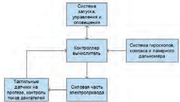
Рис. 3. Функциональная схема системы управления протезом
