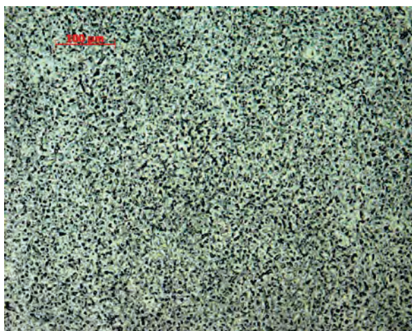
Рис.2. Структура поверхности алюминиевого сплава после поверхностного легирования титаном при зарядном напряжении 19 кВ.
