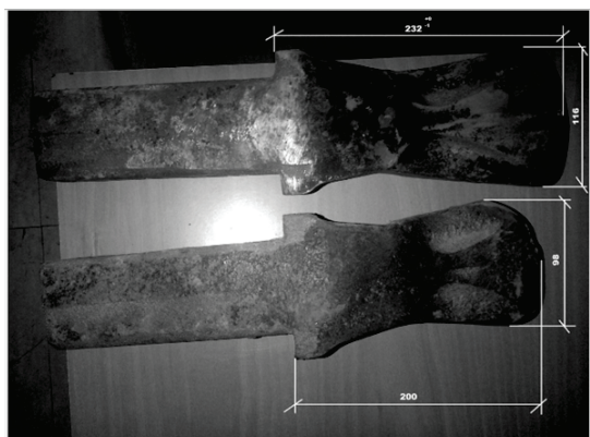
Рис.1. Зуб экскаватора до и после эксплуатации.
