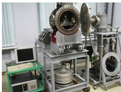
Рис.4. Стенд для испытаний ПСМ в вакууме Отличительные особенности: электрически изолированные кольца образцов, пневматическая система нагружения, измерительно-управляющая
