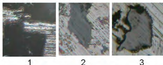
Рис 2. Коэффициент трения f_T КМ с углеродными частицами: (1) полимеризованный фуллерит + сверхупругий твердый углерод, (2) частично графитизированный сверхупругий твердый углерод и (3) сверхупругий твердый углерод. Внизу: поверхности соответствующих частиц после трибологических испытаний.
