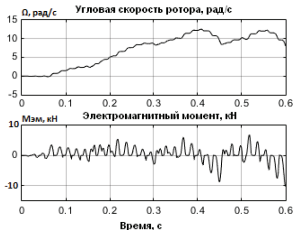
Рис. 3. Графики пуска асинхронного двигателя при квазигармоническом питающем напряжении
