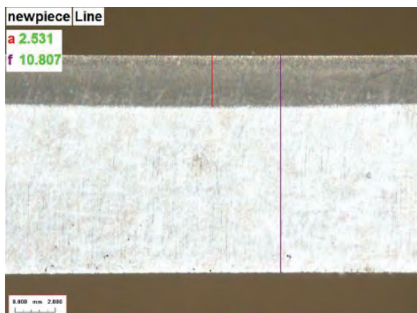
Рис. 3. Микрошлиф зоны закалки стали 40Х2НМА при мощности излучения 4000 Вт
