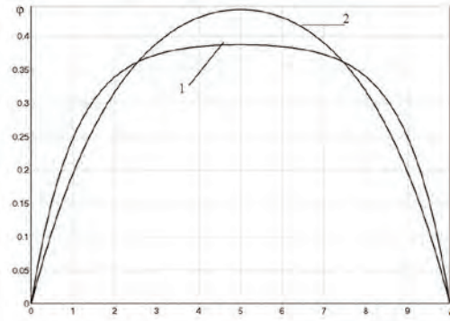
Рис. 2. Угловая скорость выходного вала двигателя в течение цикла
