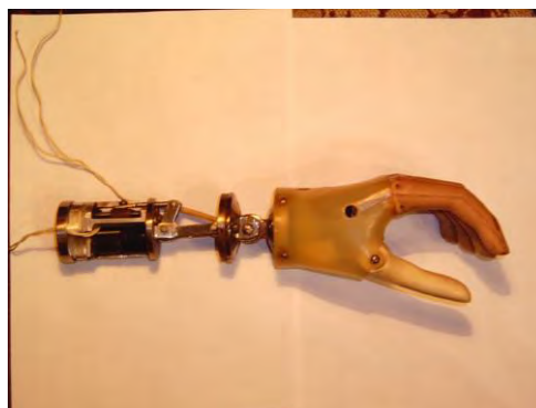
Протез кисти руки с электроприводом и оцувствлением по усилию схвата объекта
