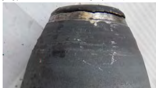
Рис.2 – Разрушение детали в месте перехода от плоской к конической части при ротационной вытяжке из листа толщиной 12 мм.
