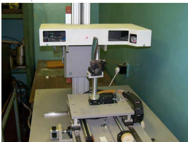
Рис. 2 Оптическая система контроля геометрических параметров пера лопатки (разработанная в ИФВТ РАН)
