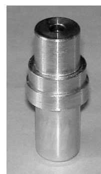
Рис. 3. Сохранение высоты и увеличение диаметра фланца при его деформации по внутренней поверхности с возможностью свободного радиального течения (сверху показана исходная заготовка, а снизу – отштампованный полуфабрикат)
