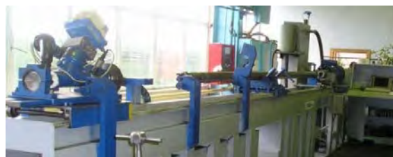
Рис.2. Стенд для испытаний насосных секций на износ.
