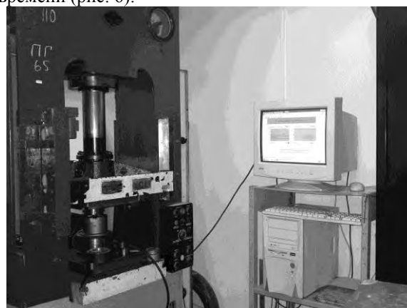
Рис. 6. Гидравлический пресс силой 650 кН с установленным экспериментальным штампом, снабжённым электротензомерами, выведенными на компьютер
