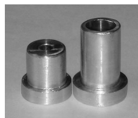
Рис. 2. Измененность высоты фланца при его деформации по внутренней поверхности с возможностью свободного радиального течения (слева показана исходная заготовка, а справа – отштампованный полуфабрикат)
