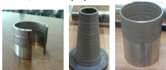
Рис. 2. Образцы выращенных заготовок из порошка на основе никеля 1535-30
