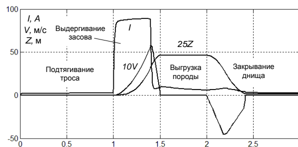
Рис. 3. Осциллограммы процессов для тока двигателя, скорости и перемещения засова в электроприводе ОДК
