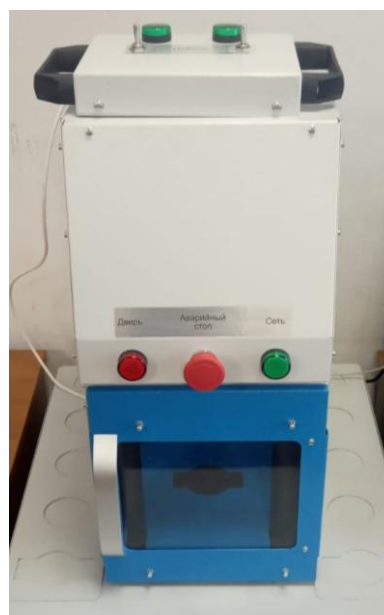
Рис. 7. Автоматизированный лабораторный комплекс «Компьютеризированный пресс с ЧПУ» ОМД – 1 ЧПУ
