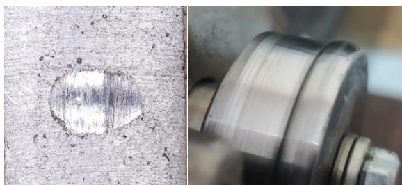
Рис. 6. Внешний вид пятен износа и обоймы после испытаний образца, армированного сталью при нагрузке 84,6 кгс
