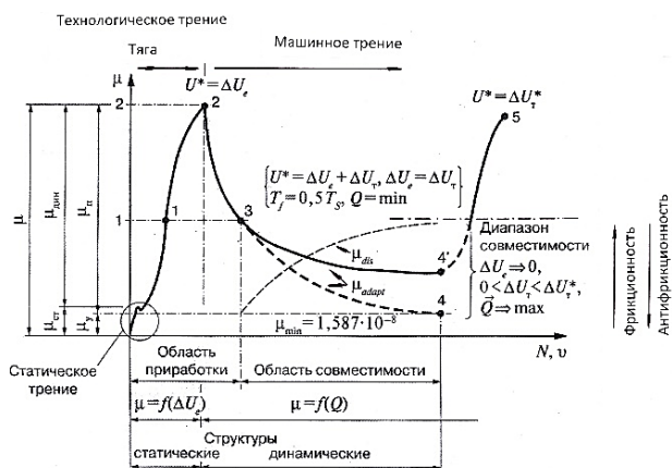
Рис. 1. Структурно-энергетическая диаграмма эволюции трущихся поверхностей (контакта трения) [2]. Обозначение на осях: N, v — нагрузка и скорость; \mu_{ст}, \mu_{дин}, \mu_{упр}, \mu_{пл} — статический, динамический, упругий, пластический коэффициенты трения; T_f, T_s — температура вспышки в контактом объеме трения в точке 3 и температура плавления
