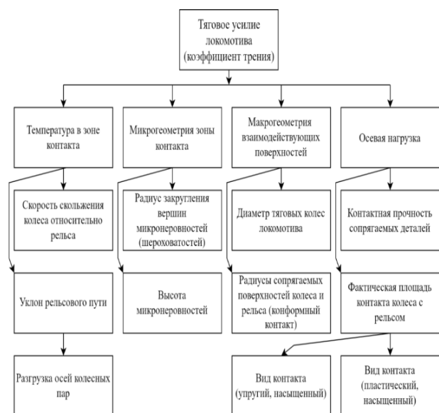
Рис. 1. Основные факторы, определяющие величину тягового усилия карьерного локомотива
