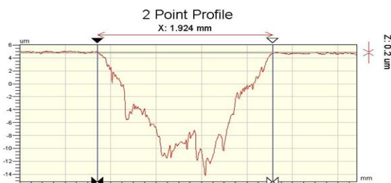
Рис. 1. Вид поперечного профиля дорожки износа пластины в области максимальной глубины износа
