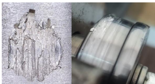
Рис. 4. Внешний вид пятен износа и обоймы после испытаний образца без армирования при нагрузке 84,6 кгс
