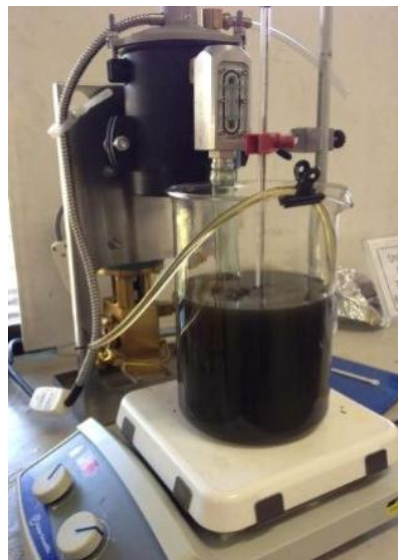
Рис. 1 Установка для испытаний системы фильтрации GLW
