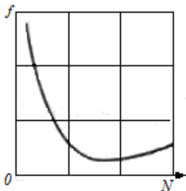
Рис. 2. Типичная кривая зависимости коэффициента трения от нагрузки [1]
