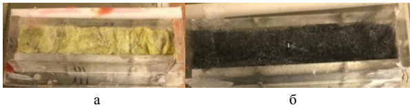
Рис. 1. Армирующие элементы, уложенные в форму перед заливкой воском: а – базальт, б – сталь.
