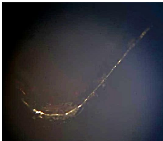
Рис. 6. Износ на задней внутренней поверхности режущей кромки ножа центробежной свеклорезки ( I_n = 0,3 мм). Увеличение \times 100
