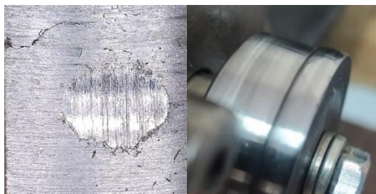
Рис. 5. Внешний вид пятен износа и обоймы после испытаний образца, армированного базальтом при нагрузке 84,6 кгс
