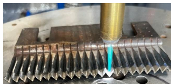
Рис. 3. Плазменное упрочнение режущих кромок свеклорезных ножей
