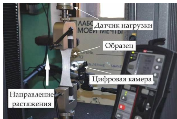
Рис. 1. Схема установки при испытании на растяжение с одновременным измерением параметров структуры
