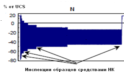
Рис. 1. Схематическое представление последовательности приложения нагрузок воздушного этапа программы "TWIST" (UCS - предел прочности образцов на статическое сжатие)
