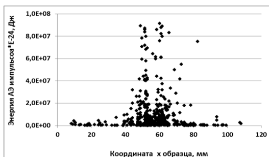
Рис. 3. Распределение энергий ( E \leq 10^{-16} Дж) отдельных АЭ импульсов по длине образца. Две зоны деструкции.
