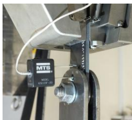
Рис. 8. Установка проушины в испытательной машине.
