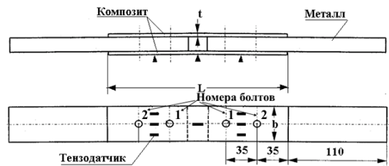
Рис. 3. Схема металло-композиционного двухрядного образца.
