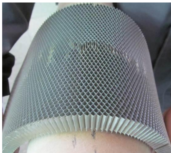
Рис. 2. Формообразование сотовой структуры
