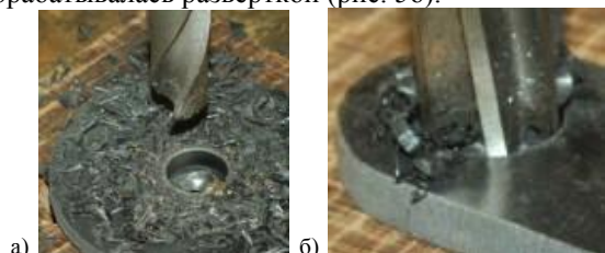
Рис. 5. Механическая обработка отверстия: а) сверление, б) развертка.
