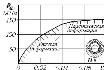
Рис. 2. Зависимость удельной мощности деформации материала МАС-1 от номинального давления.
