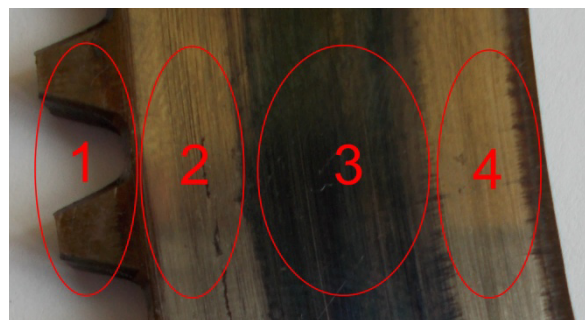
Рис. 1. Области диска стального работающего в условиях граничной смазки в паре с металлокерамическим материалом МК-5.
