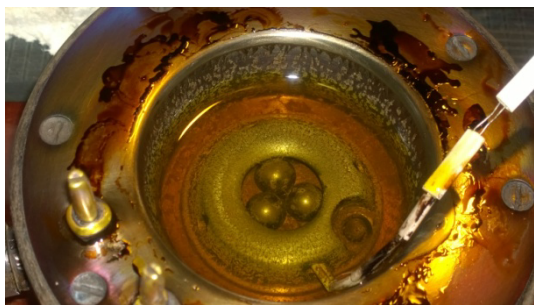
Рис. 2. Чаша после испытания ПАО-4+2%ДФ-11.
