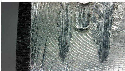
Рис. 2. Фото исследуемых рисок на образце стали 09Г2С.
