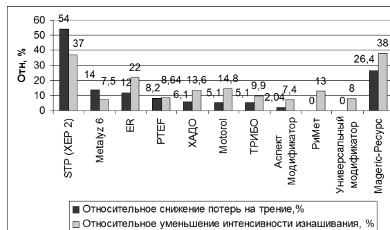
Рис. 1. Эффективность по снижению трения и изнашивания для типичных трибологических составов, распространенных на отечественном рынке присадок-добавок
