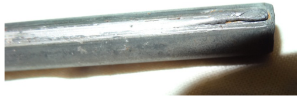
Рис. 1. Износ поверхности с одной стороны стержня с разрушением оксидных покрытий и смачиванием поверхности свинцом
